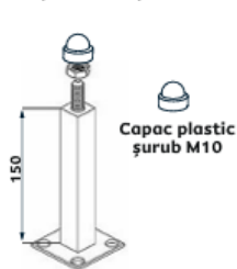
⑤B Suport talpă cu șurub de prindere premontat
